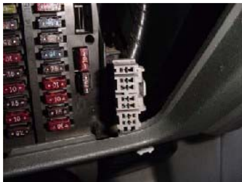
Рис. 5-1. Внешний вид диагностического разъема CONSULT.
